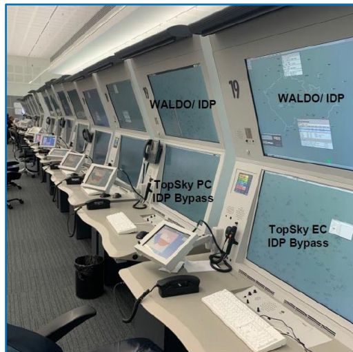
Obrázek 7: Systémové rozvržení na pozici ACC (Area Control, oblastní služba řízení), zdroj: ŘLP ČR
