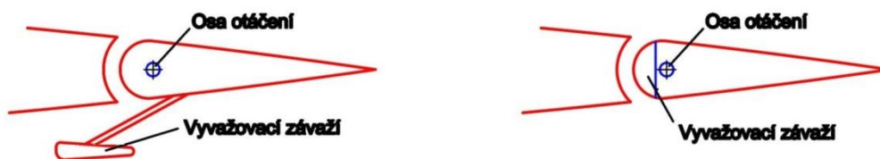
Obrázek 3.14 A) Vyvažovací závaží umístěné na konzole, B) Vyvažovací závaží umístěné v konstrukci kormidla
