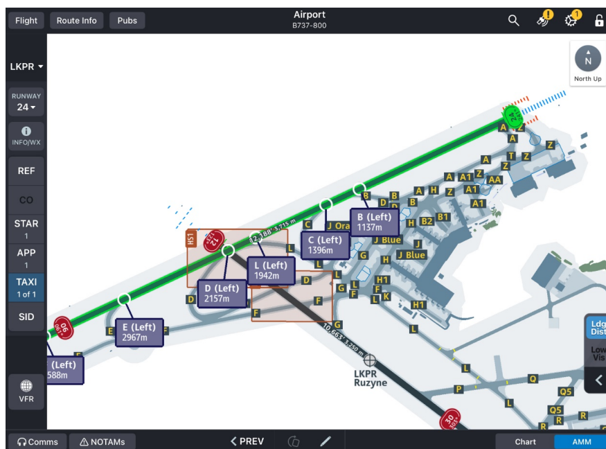
Obrázek 8: Znázornění HS1 a HS2 společně s délkami od prahu dráhy 24 k jednotlivým odbočkám na interaktivní mapě (Airport Moving Map) v aplikaci Jeppesen FliteDeck Pro X, verze 4.4
