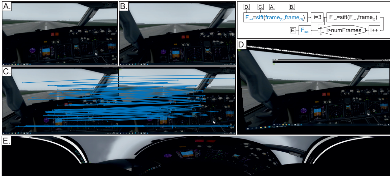
Obrázek 8: Zjednodušený proces tvorby panoramatu ze zaznamenaného videa, kde je na vstupní snímky (A,B) aplikována metoda SIFT (C) pro následné spojení obrazů (D), kde při iterování přes celkový počet snímků (numFrames) vznikne výsledné panorama (E).
