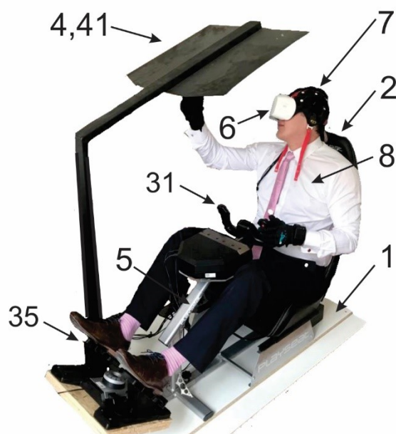
Obrázek 2: Hardwarové prostředí biofeedback dopravního simulátoru s testovacím pilotem
